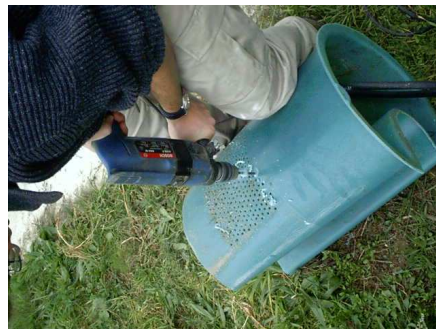
Photo 3 : Perçage des trous
